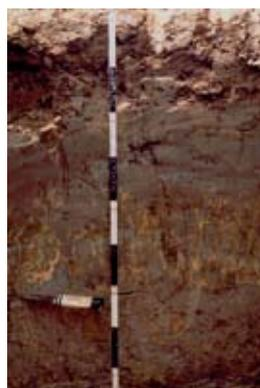
*Solo extremamente ácido (acid sulphate soil na terminologia norte-americana): o mineral de cor amarelada é a jarosite, que se forma sob condições de acidez extrema originadas pela oxidação da pirite*
