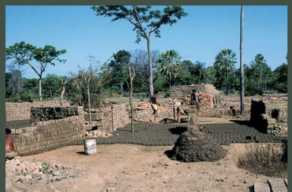
Fabrication de briques à partir de sol argileux (Brésil, Nordeste).
